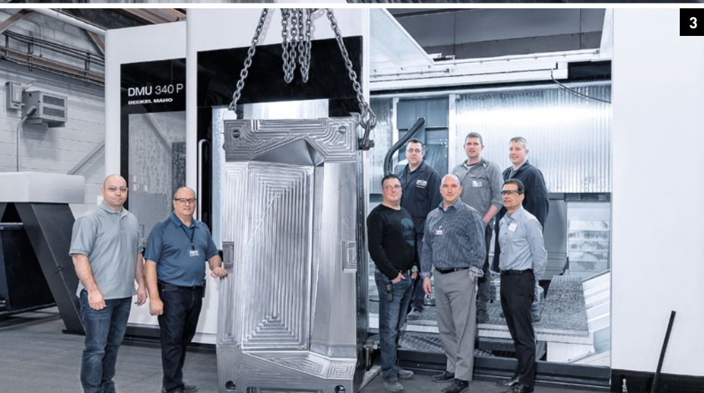
1. Usinagem sofisticada em 5 eixos na DMC 85 monoBLOCK 2. Com um sistema de troca para três paletes, a DMC 85 monoBLOCK opera até 20 horas forma autossuficiente 3. A DMU 340 P produz grandes peças com uma precisão de \pm 0,05 mm
