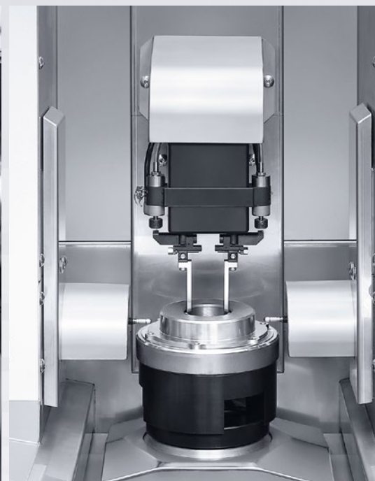
Estação de medição para medição em processo paralela ao tempo primário.
