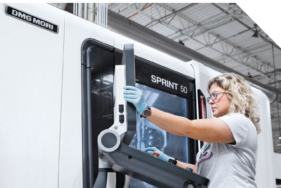
Operadora Erica Williams na SPRINT 50. O torno de produção permite o torneamento automático da barra e das peças de mandril com até 36 estações de ferramentas.
