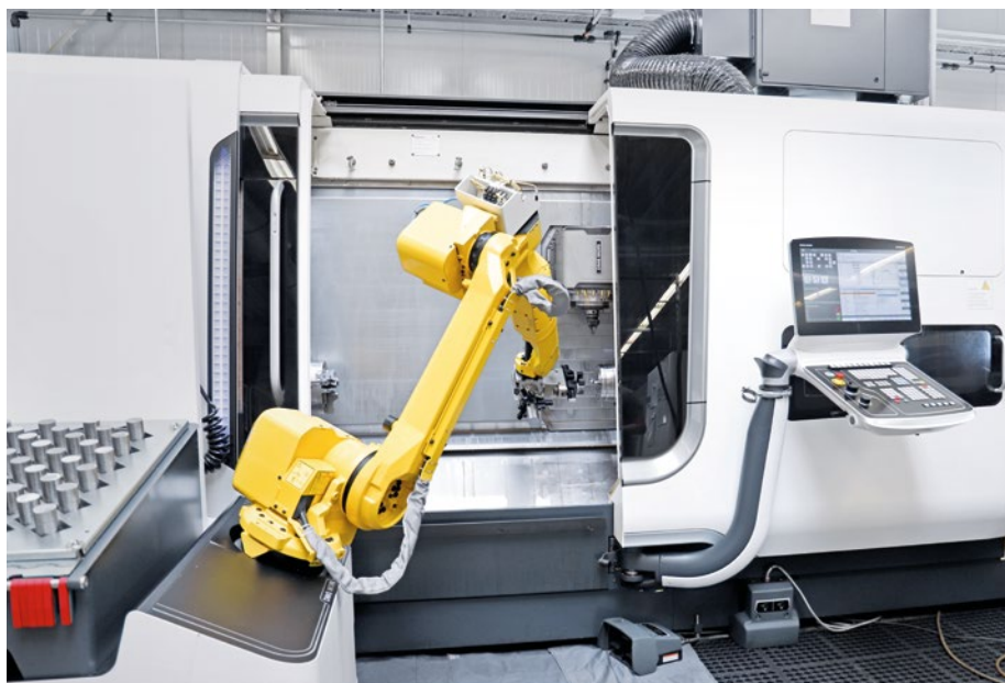
Descarga da peça acabada pelo Robo2Go do contrafuso.
