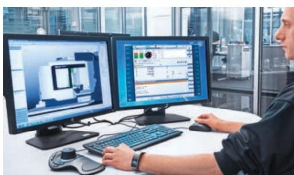
O DMG MORI Virtual Machine é uma imagem exata da DMC 160 H duoBLOCK® incluindo o comando real.
