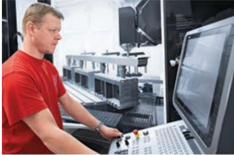
Usinagem simultânea em 5 eixos de componentes grandes na DMU 340 P.
