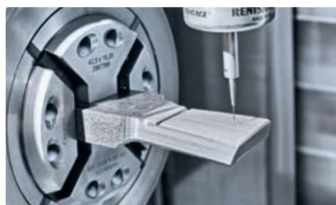
Maquinação simultânea em 5 eixos dos suportes porta lâminas de fresadoras para desbaste de barras (bar peeling) na NTX 1000.
