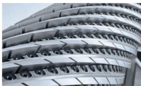
Fresadora para desbaste de barras equipada com algumas centenas de lâminas.
