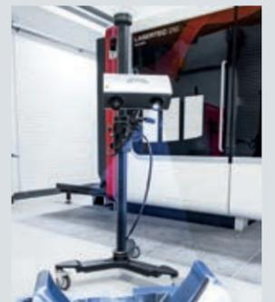
Medição da geometria de ferramentas com scanner 3D.
