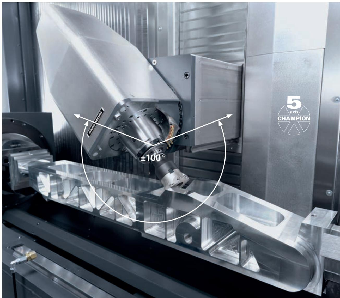
Maquinação de 5 eixos de uma travessa na DMF 26017 com quadro de tecnologia.
