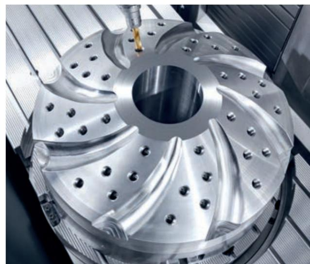
Mesa giratória NC integrada para a maquinação de 5 eixos e operações de fresagem / torneamento.
