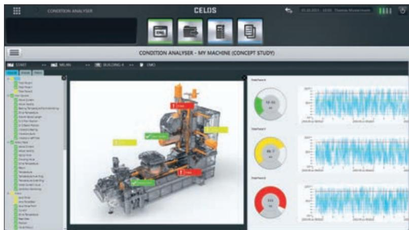
> Medição, visualização e análise de força, vibração, temperatura e lubrificação.
