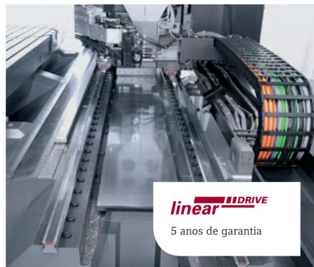
Motor linear no eixo X e até 80 m/min de avanço rápido.
