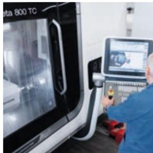
Peças altamente precisas e complexas são agora completamente torneadas e fresadas em apenas uma máquina graças à CTX beta 800 TC.
