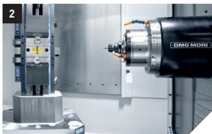
1. Usinagem completa de 6 lados em duas máquinas Turn & Mill NTX 2000 da DMG MORI.
