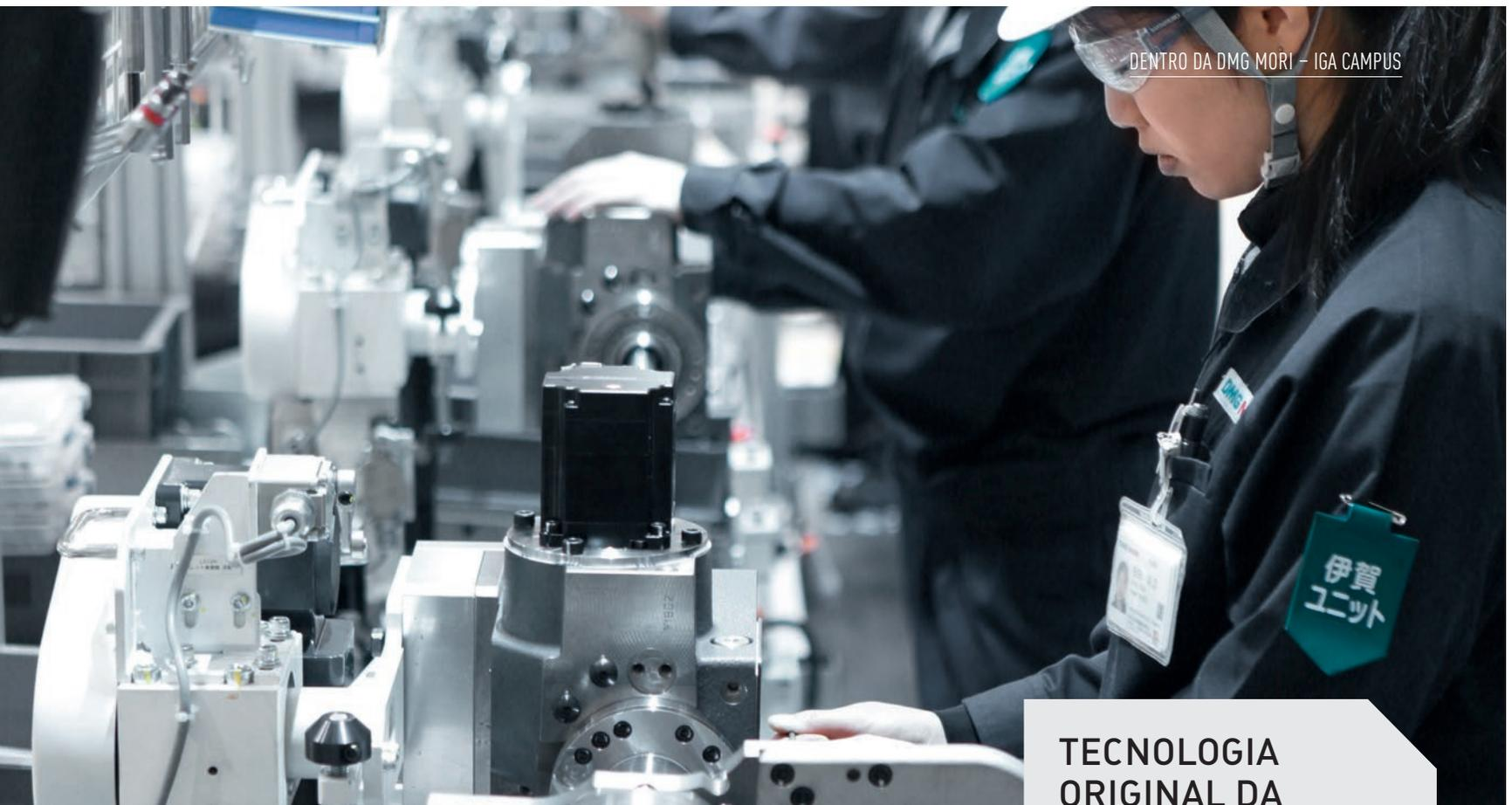
O Iga Campus é caracterizado por um alto nível de produção. Isso inclui também a produção de fusos com as séries speedMASTER, powerMASTER, torqueMASTER e compactMASTER, bem como os mandrils turnMASTER. No total, Iga produz cerca de 7.000 fusos de alta tecnologia por ano.
