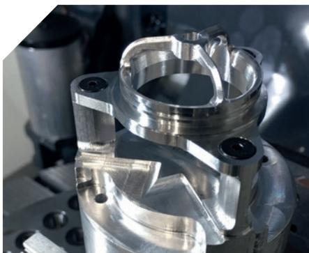
Por exemplo: Sede de válvula de alta precisão para os carros de corrida da Andretti Autosport, fabricada na fresadora universal de 5 eixos DMU 50 da DMG MORI.
