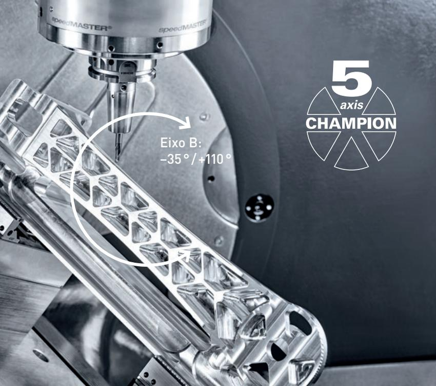
Mesa circular giratória para usinagem simultânea em 5 eixos de peças até 300 kg.
