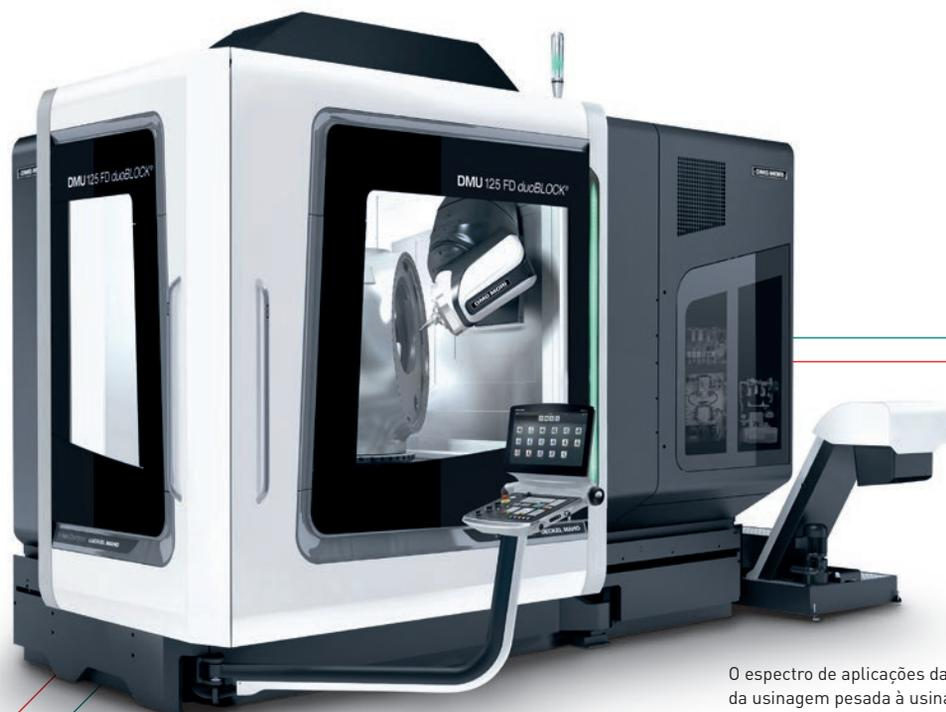
O espectro de aplicações da DMU 125 FD duoBLOCK varia da usinagem pesada à usinagem de precisão em  $\mu$  de elementos de vedação para trens de transmissão até 1.600 mm de diâmetro em uma ampla gama de materiais que variam desde o ferro fundido cinza, através do aço cromado, até o bronze.
