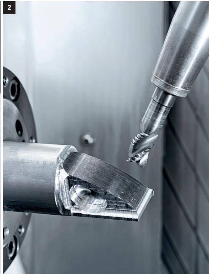
1.-3. A estabilidade e o desempenho de usinagem das máquinas DMG MORI permite a usinagem altamente precisa dos componentes protéticos complexos feitos de alumínio, aço ou titânio.
