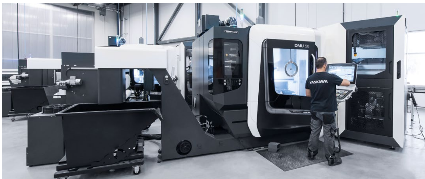
Com a produção automática na DMU 50 com WH 6 Cell, a Attabotics dá resposta, mesmo com carga de trabalho máxima, à elevada necessidade de colunas de base e outros componentes.
