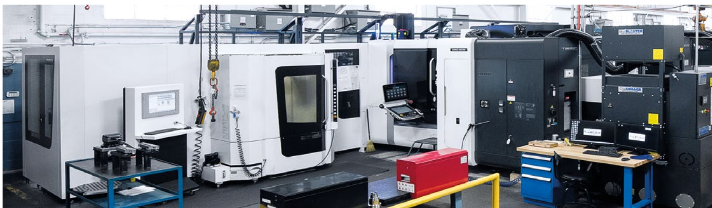
A Top Grade Molds utiliza, entre outros, quatro NHX 5000s que funcionam automaticamente com dois armazéns de paletes lineares.
