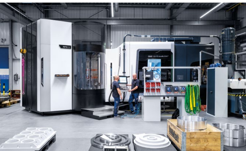
Equipada com o ciclo de retificação, a DMC 125 FD duoBLOCK permite obter qualidades de superfície de até Ra 0,4 \mu\text{m} e uma circularidade de 5 \mu\text{m}
