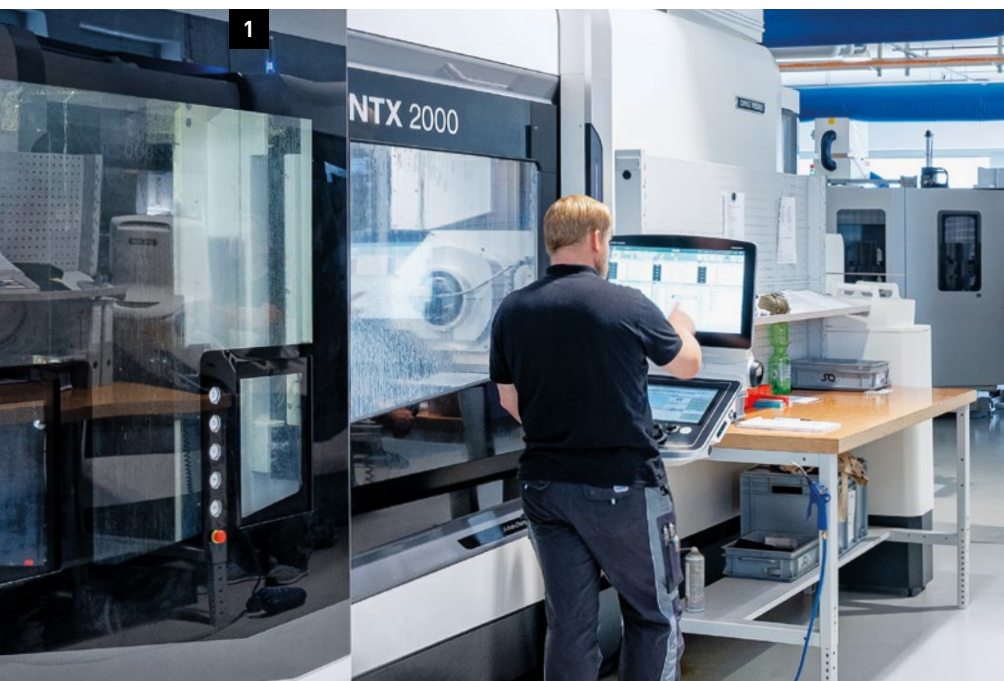
1. Com um total de seis NTX 2000, a SQ Products otimizou os processos de produção de forma tão drástica que os tempos de ciclo para as cavidades de um implante de ombro foram reduzidos de várias semanas para apenas um dia. 2. Na produção de implantes médicos, a SQ Products cumpre os mais elevados requisitos de precisão.
